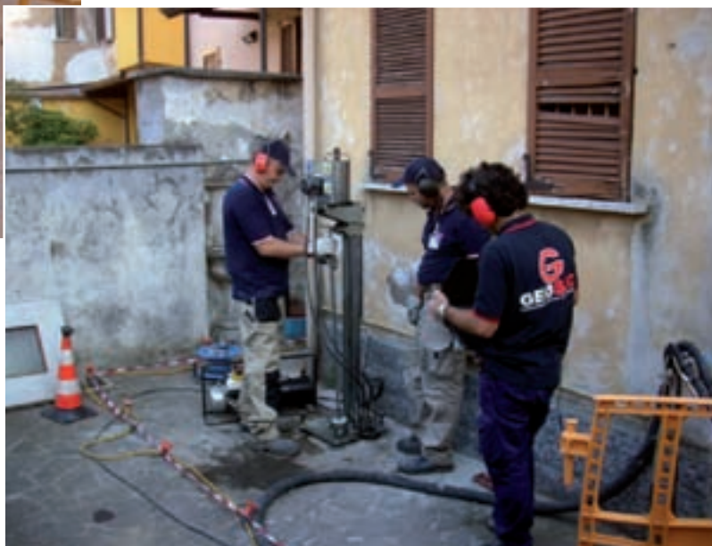
Foto a sinistra: esecuzione prova penetrometrica a consolidamento avvenuto Foto in basso: iniezione di resina
